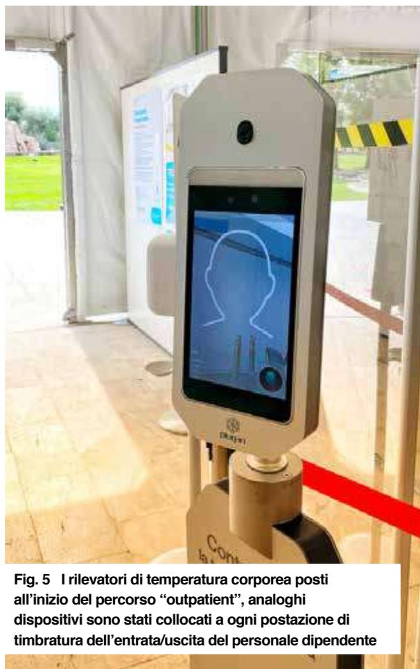
**Fig. 5** I rilevatori di temperatura corporea posti all'inizio del percorso "outpatient", analoghi dispositivi sono stati collocati a ogni postazione di timbratura dell'entrata/uscita del personale dipendente
